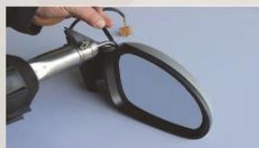
ABS پلاستیک بسیار سختی است که عموماً در خودروها و موتورسیکلت‌ها بکار می‌رود. پلاستیک‌های بکار رفته در سپر ماشین، محفظه آینه‌ها، جلو پنجره، چراغ ترمزهای عقب و بادگیرها و فلاپ‌های موتورسیکلت‌ها توسط این الکترودها جوشکاری می‌شوند.
